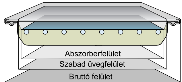
19. ábra Síkkollektorok felületei
